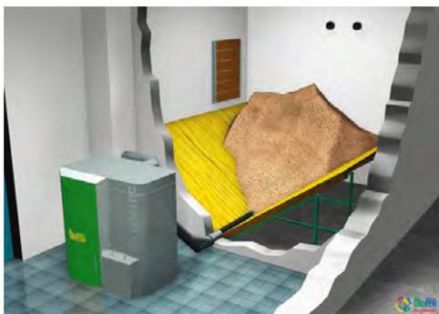
I requisiti tecnico-contruttivi di questi depositi sono definiti nella ONORM M7137, attualmente in fase di revisione (Figura 2.7). Si tratta per lo più di depositi ricavati da spazi esistenti prossimi al vano tecnico della caldaia.
