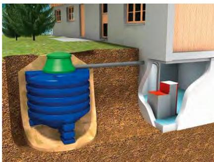
Il pellet può essere immagazzinato anche in serbatoi sotterranei di forma cilindrica o sferica, fatti in cemento armato, vetroresina o particolari materiali plastici.
