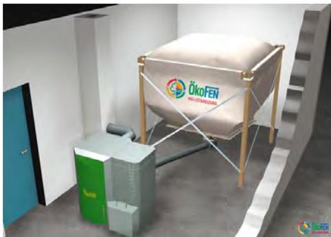
Sono dei silos di tessuto sintetico a sezione quadrata, montati su un telaio metallico. Le misure della base arrivano fino a 2,2x2,5 m per un'altezza massima di 5 m. Rappresentano una soluzione pratica e conveniente, di facile installazione. Inoltre, le pareti essendo traspiranti, fanno da filtro nei confronti della polvere che si forma durante il pompaggio del pellet, perciò non è necessario montare il sistema filtro ad aspirazione (secondo bocchettone).
