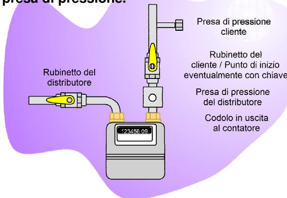
**Gli impianti interni devono essere dotati di una presa di pressione facilmente accessibile e ad uso esclusivo dell'utente.**
